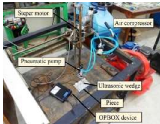
شکل ۱۵- تجهیزات مورد استفاده در روش التراسونیک
