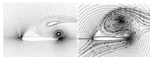
شکل ۷- بردارهای سرعت حول ایرفویل ناکا ۰۰۱۲ تحت زاویه حمله ۳۰ درجه در جریان هوا با عدد شبه‌ماخ ۰/۳، الف) کار حاضر و ب) از مرجع [۲۱]
