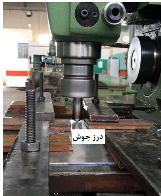
شکل ۱- جوشکاری اصطکاکی اغتشاشی نمونه مورد آزمایش
