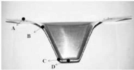
شکل ۶- نواحی اندازه‌گیری ضخامت
