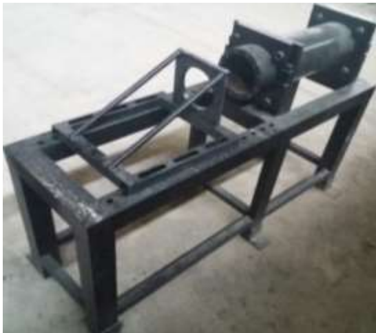
شکل ۳- لوله شاک انفجاری
