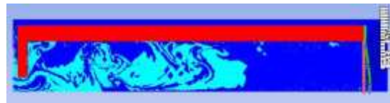
شکل ۵- مدل‌سازی لوله شاک و موج انفجار در اتوداین
