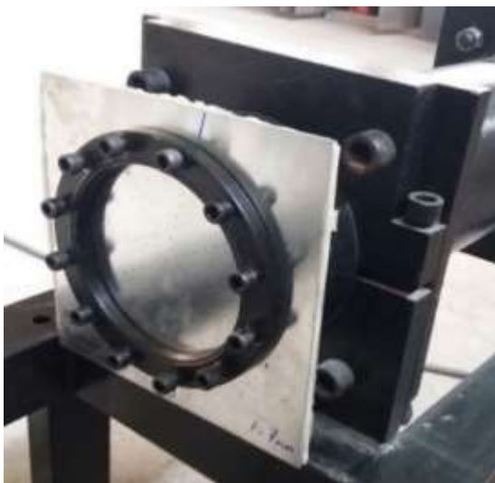
شکل ۴- اتصال تمام گیردار نمونه به لوله شاک
