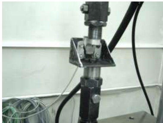
شکل ۶- ایجاد شکست خستگی در براکت درب هواپیما
