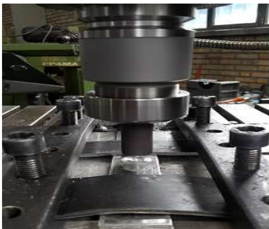
شکل ۴- نحوه جوش دو قطعه آلومینیوم غیر همنام
