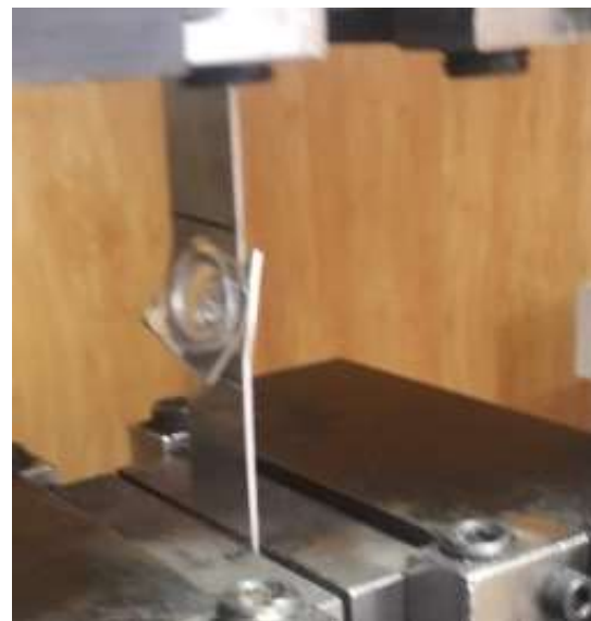
شکل ۵- نمونه‌ی در حال انجام آزمایش کشش
