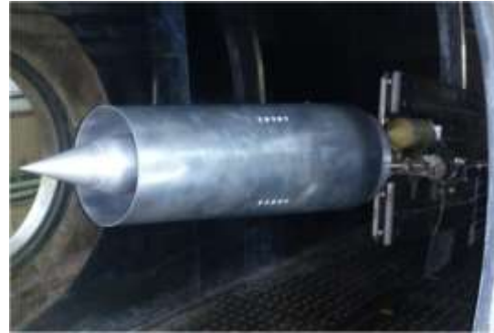
شکل ۳- مدل ورودی طراحی شده در تونل باد
