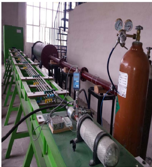
شکل ۱- سامانه تفنگ گازی [۱۶ و ۱۷]
