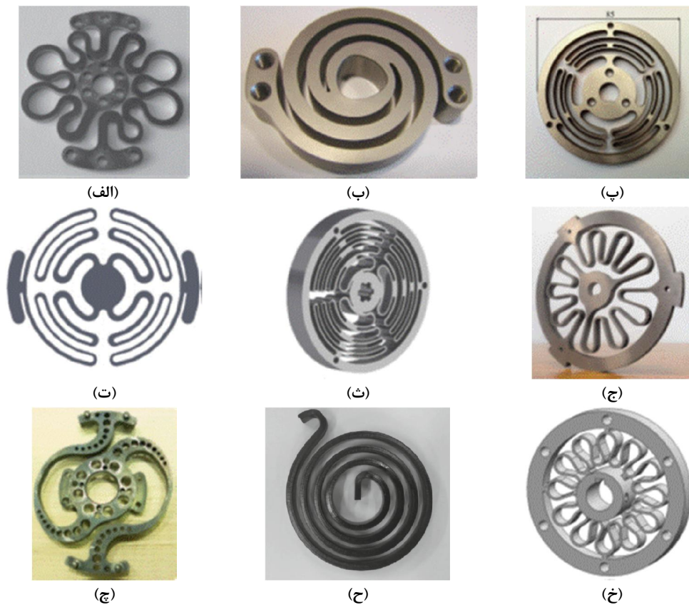
شکل ۱- هندسه‌های مختلف برای فنرهای مورد استفاده در عملگرهای الاستیک سری، پیشنهاد شده در: (الف) [۵]، (ب) [۸]، (پ) [۷]، (ت) [۱۱]، (ث) [۱۲]، (ج) [۱۳]، (چ) [۱۴]، (ح) [۱۵] و (خ) [۱۶]
