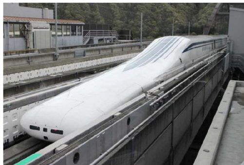
شکل ۳۵- نمونه‌ای از هندسه دماغه قطارهای تندرو جدید
