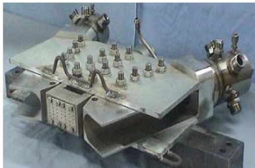
شکل ۳- مدل شیپوره آبرواسپایک با زاویه‌ی متغیر نازل [۱۵]
