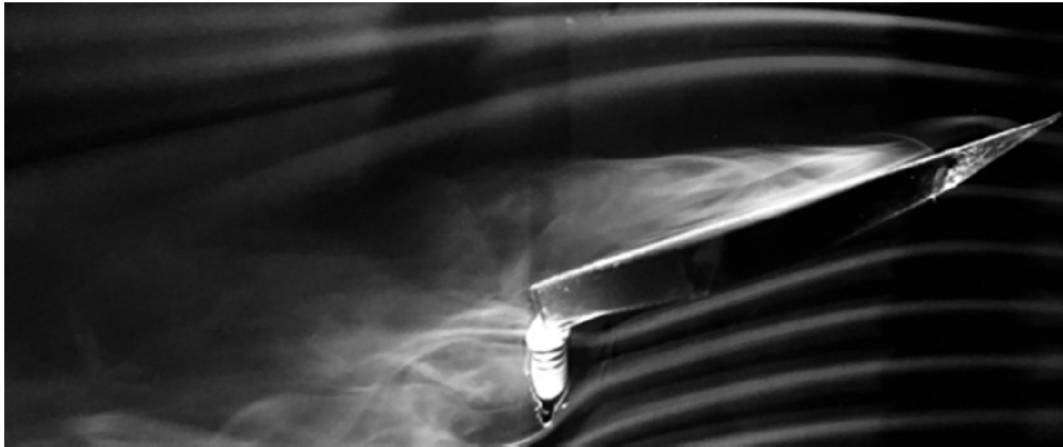
شکل ۹- آشکار سازی جریان در زاویه حمله ۲۰ درجه
