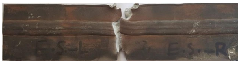
شکل ۹- مسیر رشد ترک در نمونه آزمایش
