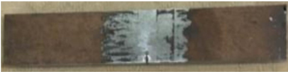
شکل ۳- نمونه‌ی حاوی درز جوش در وسط نمونه و در راستای مسیر رشد ترک آزمایش ضربه سقوطی [۱۰]
