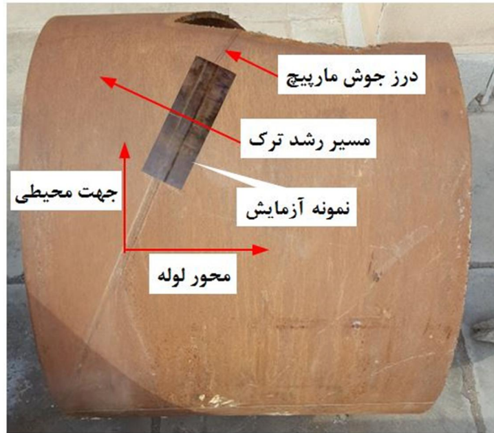
شکل ۴- لوله‌ی API X65 با درز جوش ماریچ و نمونه آزمایشگاهی جدا شده از آن
