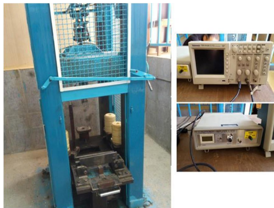
شکل ۷- دستگاه آزمایش ضربه سقوطی با ظرفیت ۳۰۰۰۰ ژول
