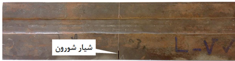
شکل ۶- شیار شورون به عمق ۵/۱ میلی‌متر در وسط نمونه آزمایش ضربه سقوطی
