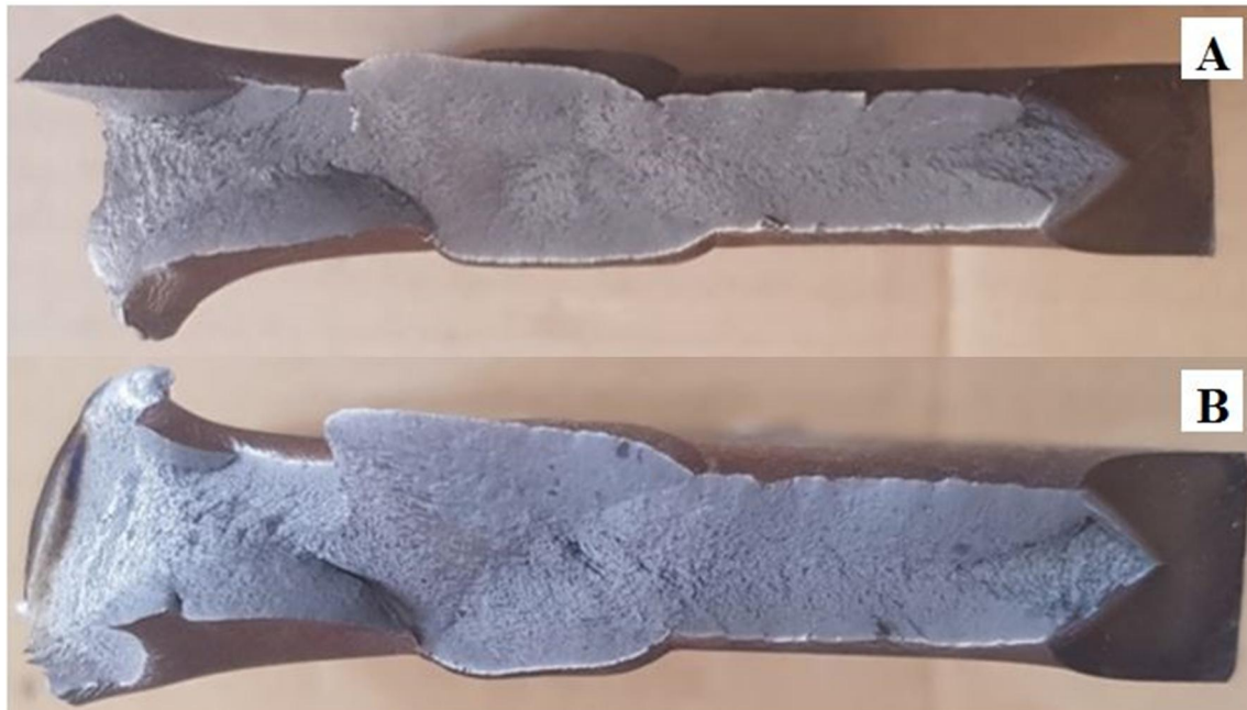
شکل ۱۰- سطح شکست نمونه آزمایش، (A) نیمه سمت چپ و (B) نیمه سمت راست
