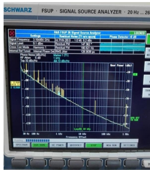
شکل (۱۷): نویز فاز اندازه‌گیری شده (محور عمودی سمت راست مربوط به سطح اسپورها و محور عمودی سمت چپ مربوط به نویز فاز است).
