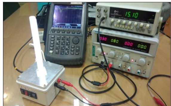
شکل (۹): اندازه‌گیری پارامترهای آنتن با دستگاه VNA
