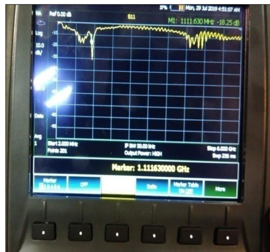
شکل (۱۰): نمونه از اندازه‌گیری پارامتر S_{11} با دستگاه VNA
