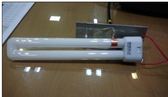
شکل (۸): نمایی از نحوه اتصالات کوپلر سیگنال و پایانه‌های تحریک
