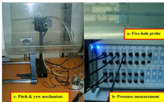
شکل (۵): تجهیزات مورد استفاده در کالیبراسیون پراب پنج حفره.
