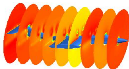
شکل (۱۹): کانتور توزیع سرعت روی صفحات عرضی گذرنده از قایق پرنده در حالت چرخش هم‌جهت ملخ‌ها در زاویه ۳ درجه.
