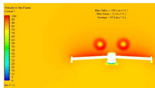
شکل (۱۷): کانتور توزیع سرعت روی صفحه عرضی گذرنده از مرکز بال در حالت چرخش هم‌جهت ملخ‌ها در زاویه ۳ درجه.
