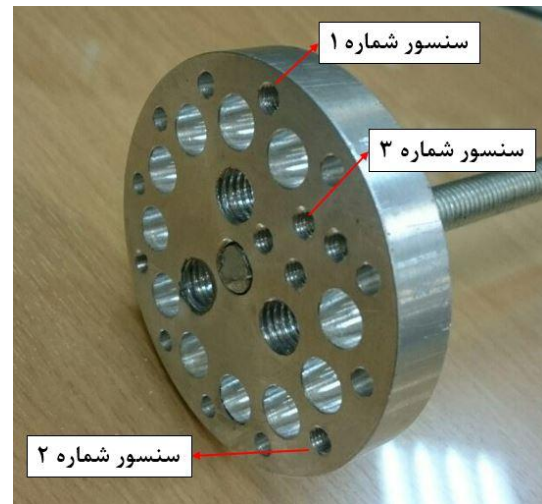
شکل (۵): فیکسچر طراحی شده برای قرارگیری حسگرها.
