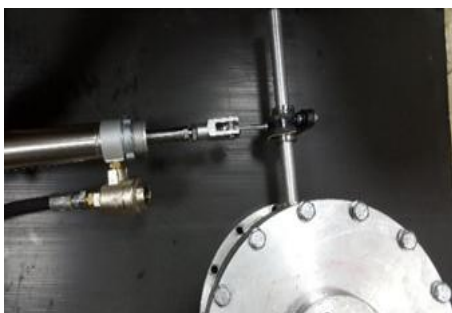
شکل (۹): تبدیل حرکت خطی پیستون به حرکت دورانی شیر.
