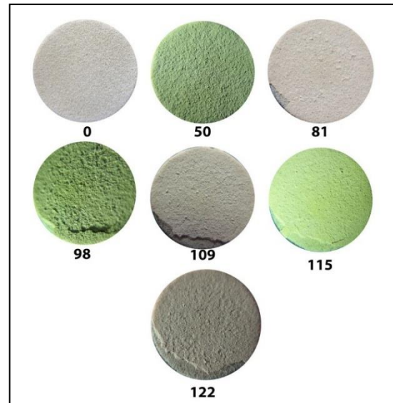
شکل ۱۰. تصاویر با دوربین دیجیتال از مراحل رشد ترک در سطح نمونه تحت شوک حرارتی قرارگرفته در 1000^\circ C .
