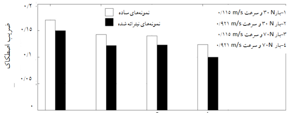
شکل ۸. مقایسه ضریب اصطکاک برای نمونه‌های ساده و نیترا ته شده.
