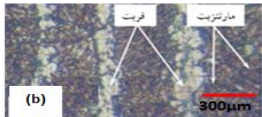
شکل ۱۴. تصویر ریزساختار نمونه سختکاری شده لیزری (a) نمونه شماره ۱ (b) نمونه شماره ۲.
