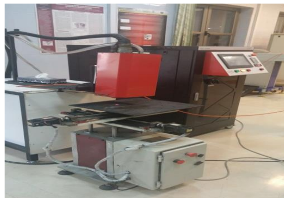
شکل ۱. تصویر دستگاه لیزر دیودی در حین فرآیند سختکاری.
