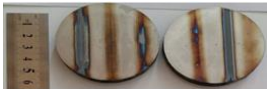
شکل ۳. تصویر نمونه‌های سختکاری سطحی شده لیزری با لیزر دیودی (قطر نمونه 65 میلی‌متر).
