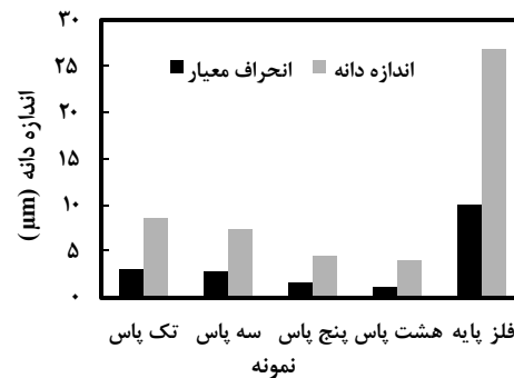
شکل ۵. اندازه دانه فلز پایه و SZ در نمونه های تک پاس، ۳ پاس، ۵ پاس و ۸ پاس.
