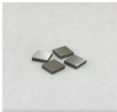
شکل ۱. زیر لایه تهیه شده از جنس فولاد ساده کربنی (CK45)
