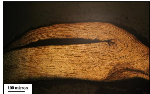
شکل ۳. شکل متالوگرافی نمونه S10-16 که در آن مغزه بندی باقی مانده در ریزساختار به صورت نوارهای تیره و روشن در راستای طولی نمونه قابل مشاهده است.
