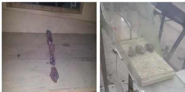
شکل ۱۵. نمای کلی از نحوه‌ی قرارگیری نمونه‌ها در دو مقطع تونل باد.
