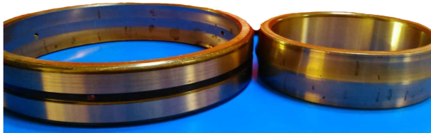
شکل ۵. تصویر یاتاقان‌های پمپ با علامت خرابی در رینگ داخلی.
