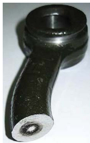
شکل ۶. نمونه آزمایشی بعد از آزمایش اسپکترومتری.
