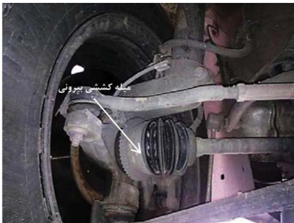
شکل ۳. جانمایی میله کششی بیرونی در خودرو پژو ۴۰۵.
