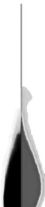
شکل ۵. مقایسه‌ی شماتیک نتایج عددی (راست) و تجربی (چپ) در T_w = 20^\circ C و G_e = 50 \text{ kg/m}^2 \text{ s} و Re_w = 8351 .
