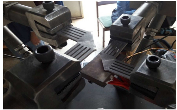
شکل ۶. شکست نمونه‌ی صلیبی از آلیاژ آلومینیوم ۵۰۸۳.
