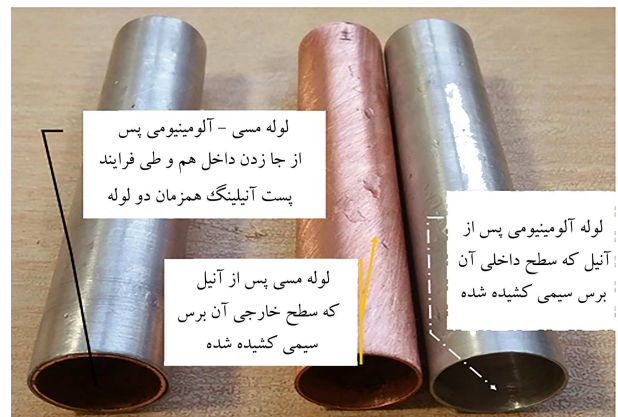
شکل ۳. لوله‌های آلومینیومی و مسی آنیل شده و برس خورده در سطوح درگیر و سپس جا زدن آنها داخل هم.
