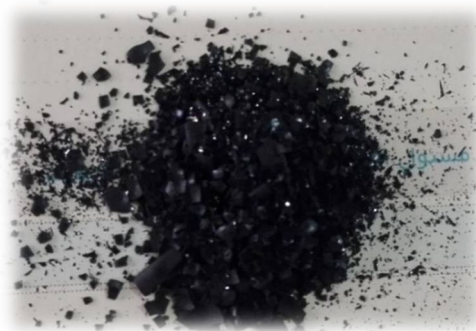
شکل 1. نانوذرات اکسید آهن به روش هیدروترمال اصلاح شده.
