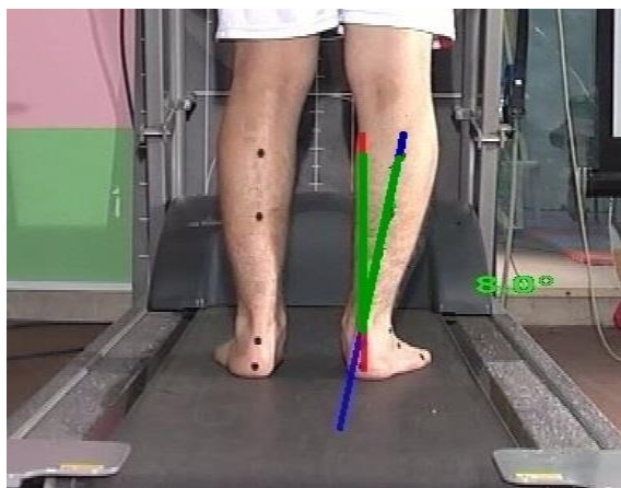
تصویر ۲: روش اندازه‌گیری مقدار زاویه پشت پا به وسیله سیستم آنالیز حرکت
