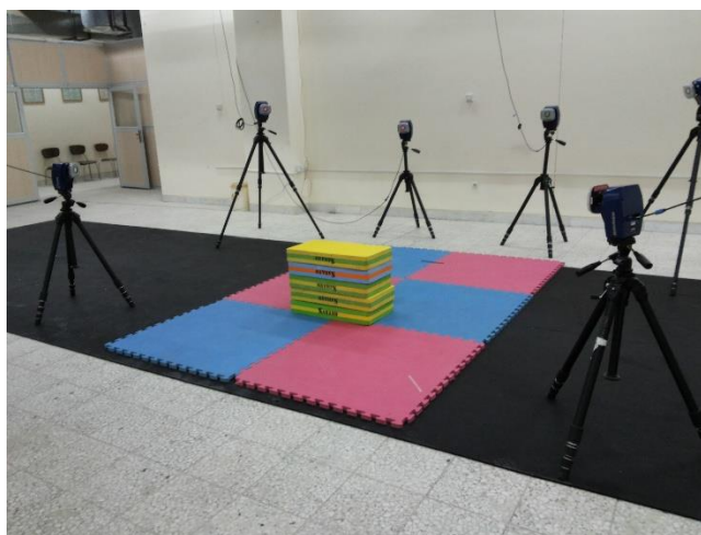
تصویر ۲: نحوه چیدمان شش دوربین اپتوالکترونیک
