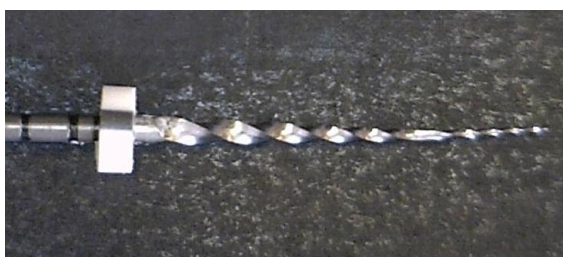
تصویر ۳: تصویری از باز شدگی پیچ در فایل روتاری تغییر شکل یافته
