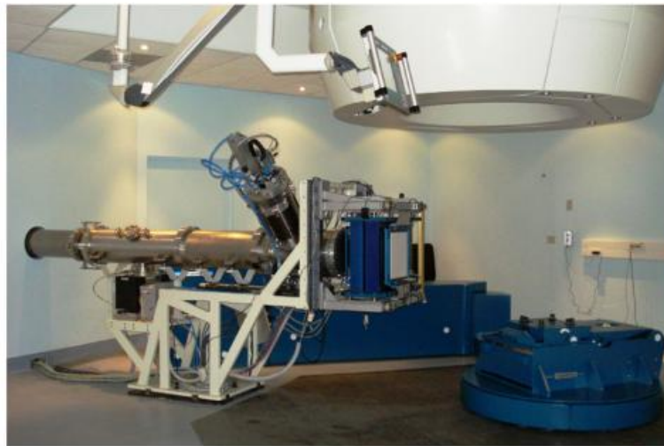
شکل ۱۳- سامانه افقی خط انتقال باریکه ثابت در اتاق درمانی مرکز CNAO در ایتالیا.
