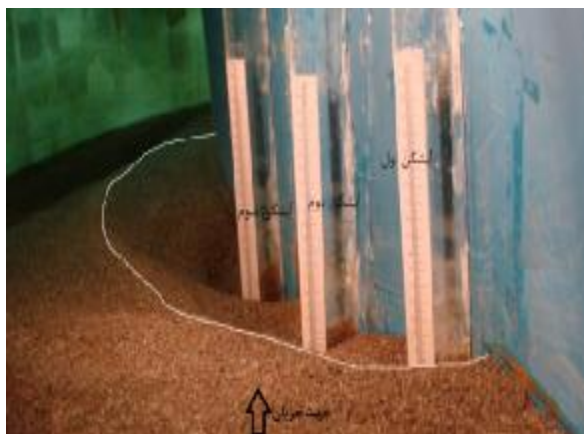
شکل 6- آبشستگی سری آبشکن‌ها به طول 5/5 سانتی‌متر.
