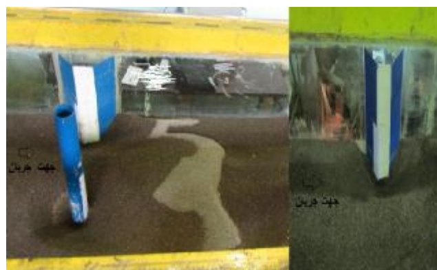
شکل 8- پروفیل بستر در آزمایش شاهد آبشکن و در حالت آبشکن و یک پایه پل.
