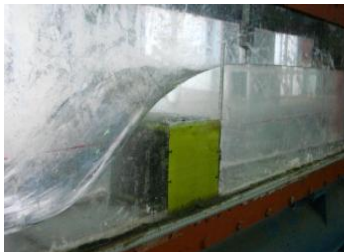
شکل 3 - سرریز گابیونی استفاده شده در این تحقیق.
