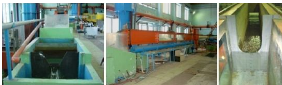
شکل 5- نمایی از سرریز لبه تیز مرکب نصب شده در فلوم آزمایشگاهی Figure 5- View of compound sharp-crested weir set up in the laboratory flume
