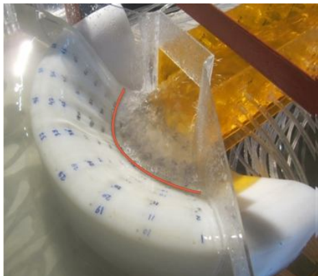
شکل 4- تشکیل پرش هیدرولیکی در پای سرریز
