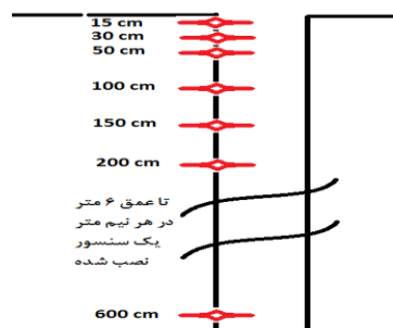
شکل ۱- حسگرهای رطوبتی نصب‌شده در اعماق ۱۵ تا ۶۰۰ سانتی‌متری
