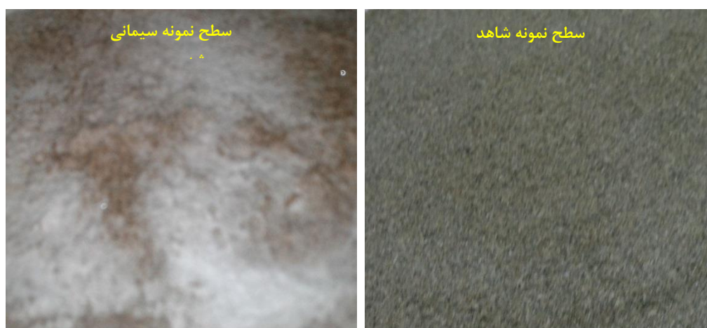
شکل ۲- تصویری از سطح نمونه شاهد و نمونه سیمانی شده با فناوری MICP
