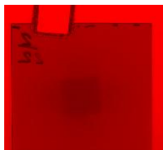
شکل ۲: (الف) فیلم گاف کرومیک EBT2 تابش دیده، برای اندازه‌گیری فاکتور پراکندگی کولیماتور با استفاده از Top سروبند و مینی فانتوم آب؛ (ب) استخراج کانال قرمز با استفاده از نرم افزار MATLAB
