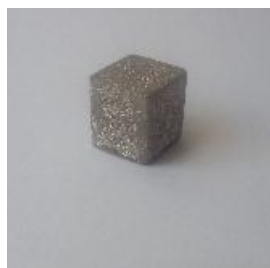
شکل ۱: مینی فانتوم‌های طراحی شده از جنس سروبند و آب برای اندازه‌گیری با فیلم گاف کرومیک EBT2
