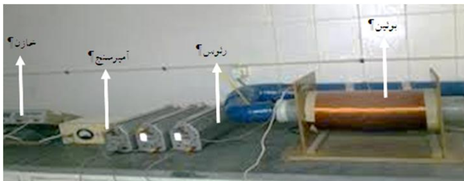
شکل ۱: سیستم انکوباسیون جوجه همراه با دستگاه مولد میدان الکترومغناطیس با فرکانس کم (طراحی شده در مرکز تحقیقاتی بیولوژی کاربردی تکونیر) (جانوری)
