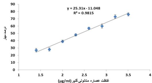
نمودار شماره ۵: نمودار خطی درصد مهار آلفا-گلوکوزیداز در مقابل لگاریتم غلظت‌های مختلف عصاره مтанولی گیاه گلپر.  $IC_{50}$  به دست آمده برابر با  $258 \mu\text{g}/\text{ml}$  می‌باشد. تست‌ها ۳ بار تکرار گردیده و نتایج به صورت  $\pm$  انحراف معیار گزارش شده است.
