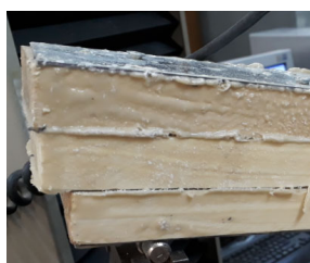
د) شکست برشی پیچ در اثر تنش برشی بین لایه ها
