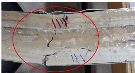
گلولام تقویت شده با ورق آلومینیوم با آرایش ۳
