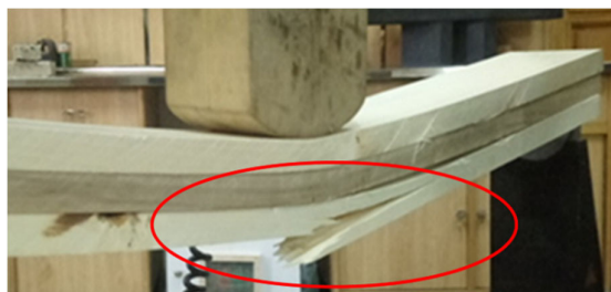
الف) شکست کششی و ترد در گلولام تقویت نشده
