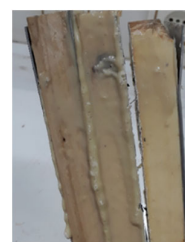
گلولام تقویت شده با ورق فولاد کالوانیزه با آرایش ۲
