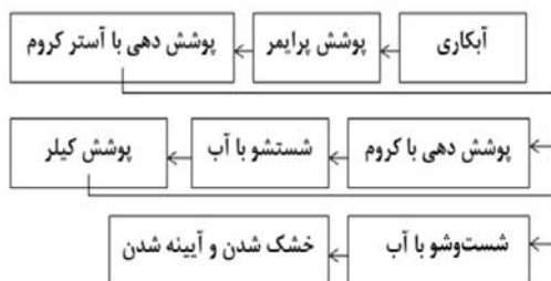
شکل ۲. ترتیب مراحل پوشش‌دهی فانتاکروم و سوپرکروم
