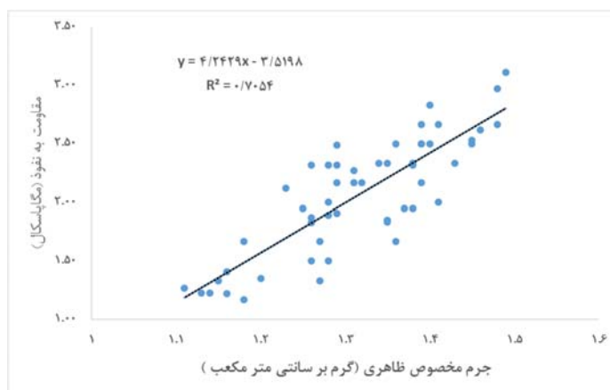
شکل ۴. رابطه توانی بین جرم مخصوص ظاهری و مقاومت به نفوذ با ضریب همبستگی ۰/۷۱
