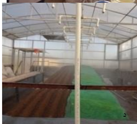
شکل 1- مراحل آماده سازی فلوم فرسایش: ریختن سنگریزه به ضخامت 5 سانتی متر (الف)، ورن کردن مقدار خاک مورد نیاز برای هر لایه 5 سانتی متری (ب)، ایجاد شیار (ج) و فلوم شبیه سازی شده برای حالت با ضربه قطرات باران (سمت چپ)، برای حالت بدون ضربه قطرات باران (سمت راست) (د)
