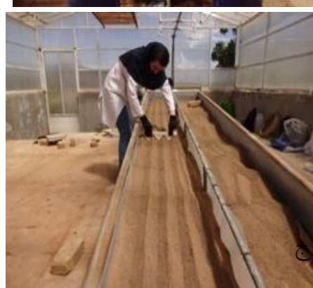
شکل 1- مراحل آماده سازی فلوم فرسایش: ریختن سنگریزه به ضخامت 5 سانتی متر (الف)، ورن کردن مقدار خاک مورد نیاز برای هر لایه 5 سانتی متری (ب)، ایجاد شیار (ج) و فلوم شبیه سازی شده برای حالت با ضربه قطرات باران (سمت چپ)، برای حالت بدون ضربه قطرات باران (سمت راست) (د)
